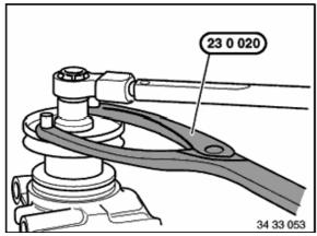
Maintenir la bride d'entraînement au moyen de l'outil spécial 23 0 020 et desserrer l'écrou à embase.
