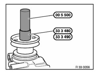
Emmancher une nouvelle plaquette arrêtoir avec les outils spéciaux suivants (selon le pont arrière).
