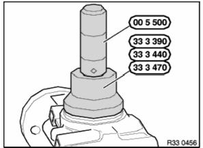
Emmancher jusqu'en butée un nouveau joint à lèvres avec les outils spéciaux suivants (selon le pont arrière).
